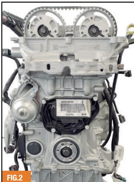
possuem em sua parte dianteira um encaixe, com uma face arredondada e 3 faces planas (Fig. 3), nas quais é instalada a ferramenta 161015-00B. Cada árvore de comando também possui um sextavado entre os cames do 1º e 2º cilindros e gravações entre os cames do 2º e 3º cilindros.
