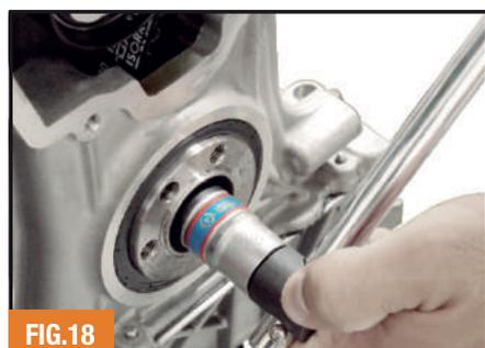
**Aviso:** Descarte o parafuso de fixação do cubo da polia (das correias poly-v) da árvore de manivelas, pois o mesmo sofreu aumento no seu comprimento original, devido ao torque angular anteriormente aplicado na sua montagem.
